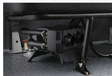
Дополнительный отопитель кабины
